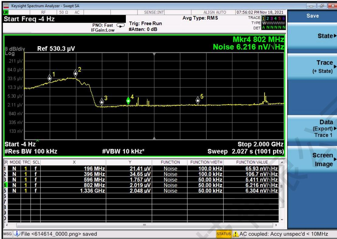
图 9 Thor Lab APD430 (带宽 400MHz) 噪声谱密度
